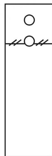
Рисунок В.12 — Разрушение при сжатии типа LGO: поперечное разрушение по краю отверстия (как правило, происходит вдоль направления армирования 0^\circ )
