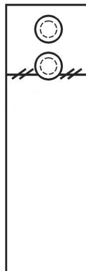
Рисунок В.14 — Разрушение при сжатии типа LGF: поперечное разрушение по краю крепления, гайки, шайбы (как правило происходит вдоль направления армирования 0°)
