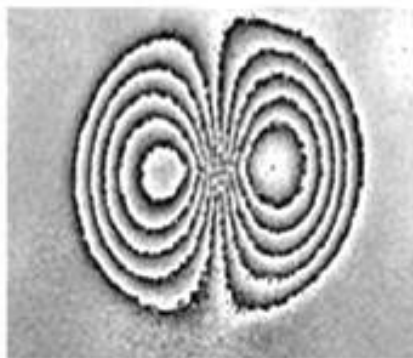
Рисунок 3 — Шерограмма с областью локального перемещения
