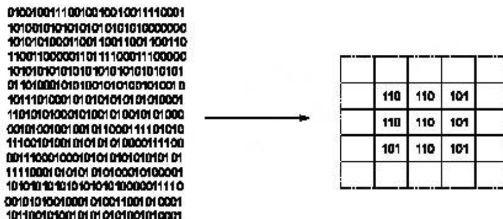
Рисунок ДЕ.2 — Распределение двоичных данных в пиксельной матрице (двоичная матрица 3 × 3)
