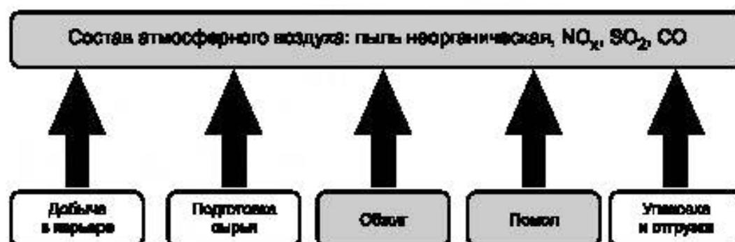
Рисунок 1 — Принципиальная блок-схема производства цемента, где основное воздействие оказывается на атмосферный воздух
