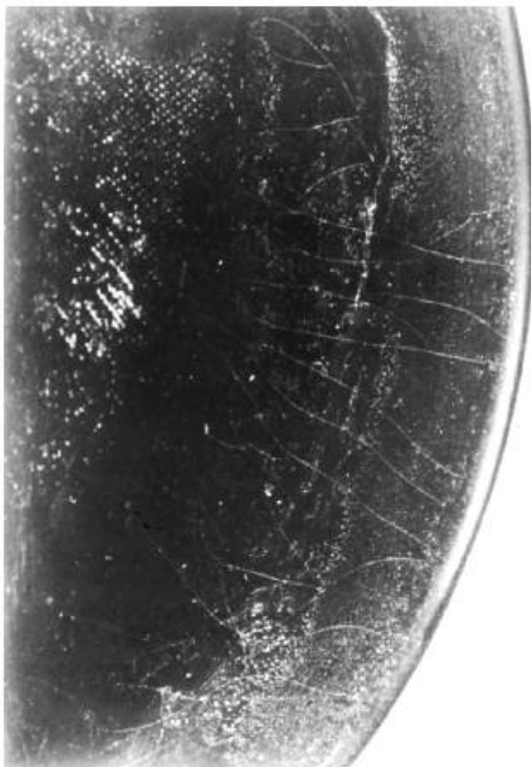
Рисунок А.2 — Волосная трещина
