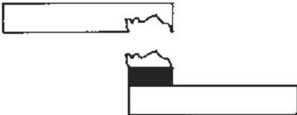
Рисунок А.4 — Схематическое изображение разрушения из-за разрыва волокон
