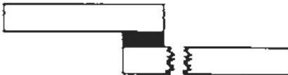
Рисунок А.6 — Схематическое изображение разрушение из-за разрыва материала
