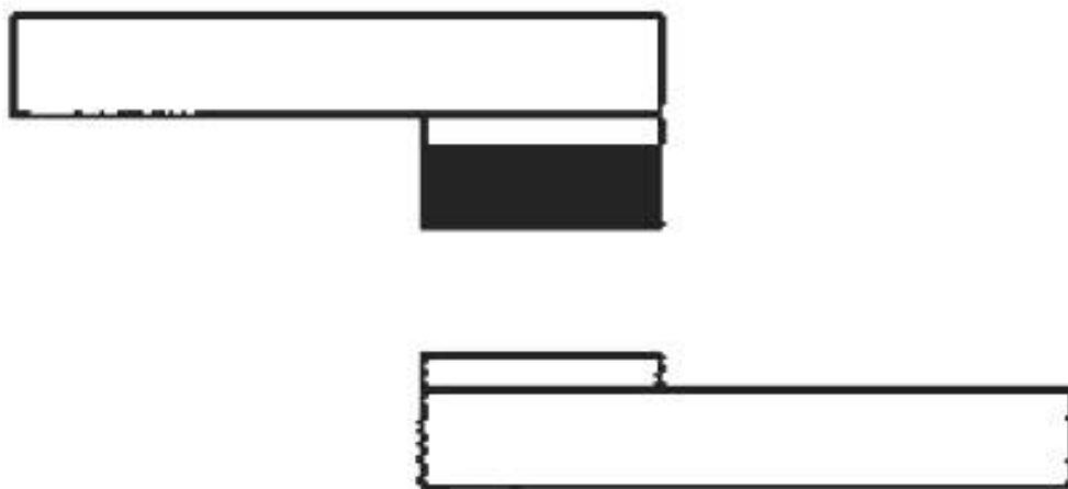
Рисунок А.7 — Схематическое изображение разрушения на границе «клей — ускоритель склеивания»
