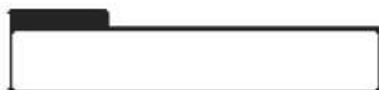
Рисунок А.2 — Схематическое изображение когезионного разрушения
