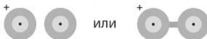
Рисунок 12а — Одно- или многожильные кабели с экранированием и изоляцией каждой жилы
