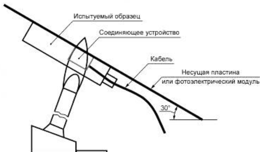
Рисунок 1 — Типичная установка для проведения испытаний на воспламеняемость коммутационной коробки в сборе
