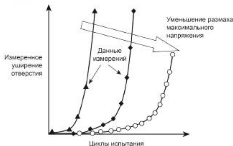
Рисунок 3 — Типичная зависимость расширения отверстия от количества циклов нагружения
