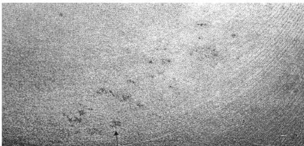
Рисунок А.13 — Интерметаллиды
