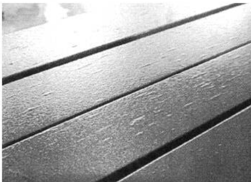
Рисунок А.53 — Пузыри на окрашенном профиле
