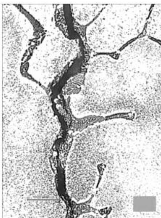
Рисунок А.19 — Трещина волосовидная
