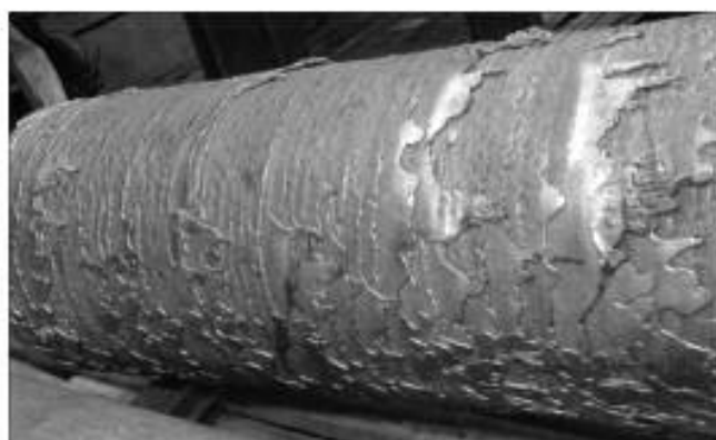
Рисунок А.16 — Пролив расплава
