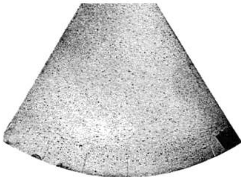
Рисунок А.27 — Пористость
