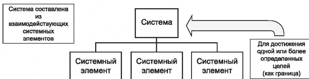
Рисунок 1 — Пример системы и отношений между системными элементами
