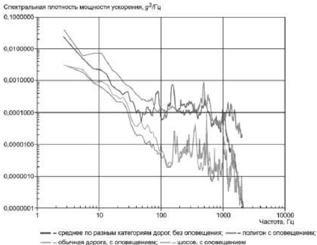
Рисунок 7 — Сравнение результатов измерений вибрации в вертикальном направлении по программе SRETS для разных категорий дорог с оповещением и без оповещения водителей о цели испытаний
