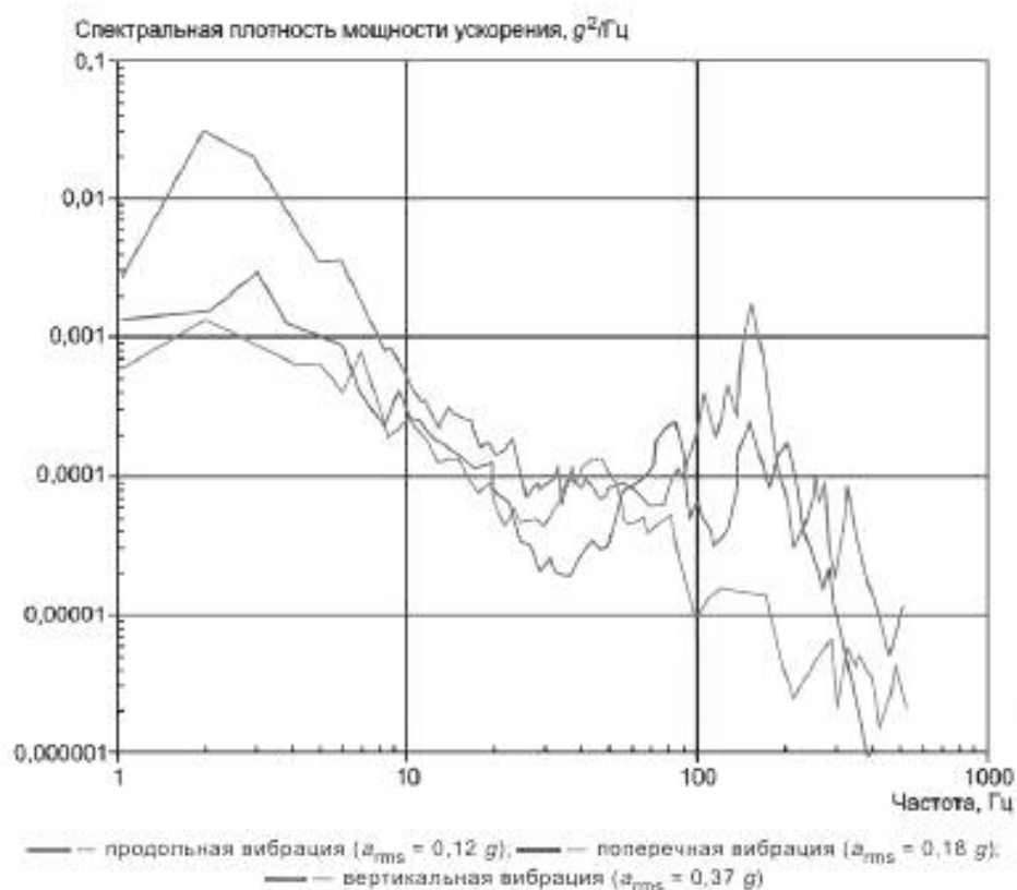
Рисунок 26 — Спектральные плотности распределения для измерений CEEES по разбитым дорогам (скорость 24 км/ч)
