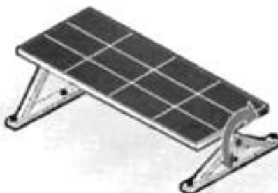
Рисунок 3 — Пример наклонной одноосной системы слежения за Солнцем
