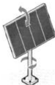
Рисунок 7 — Пример двухосной системы слежения за Солнцем с вертикальной основной осью
