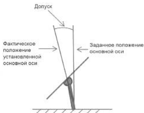
Рисунок 8 — Пример допуска по положению основной оси для двухосной системы слежения за Солнцем с вертикальной основной осью
