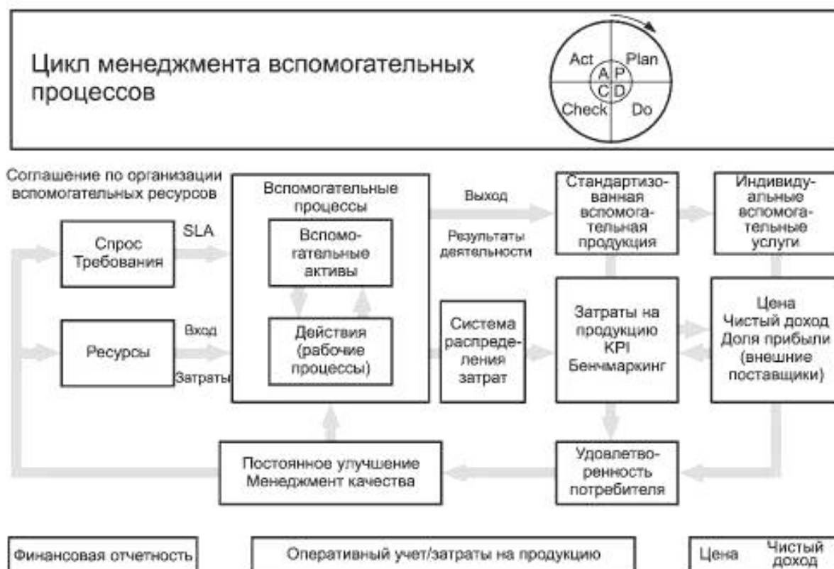
Рисунок Е.1 — Цикл управления недвижимостью, показывающий взаимосвязь между процессами и затратами, применение цикла качества (PDCA) для этой связи и соответствующие системы учета
