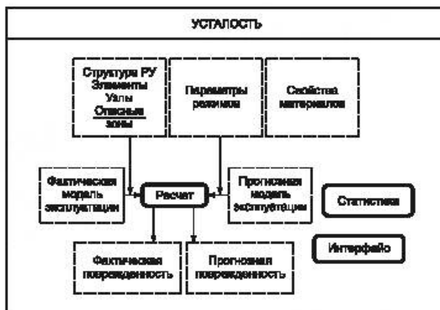
Рисунок 7 — Схема работы расчетного модуля «Усталость»
