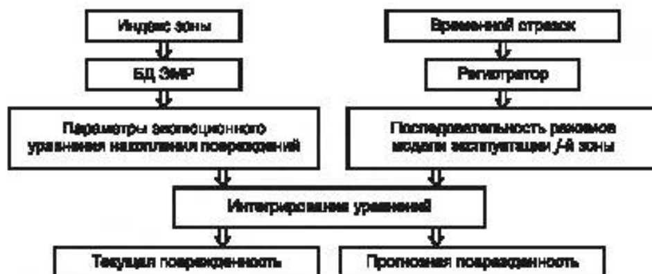
Рисунок 10 — Схема работы модуля оценки поврежденности контролируемых зон конструктивных элементов
