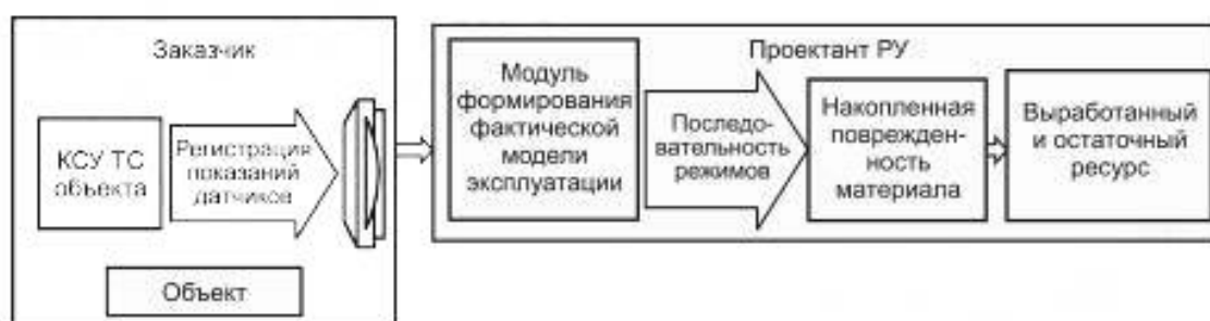
Рисунок 12 — Схема организации работ при эксплуатации СЭМР
