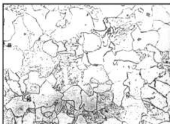
Балл 6, 500 \times , химическое травление
