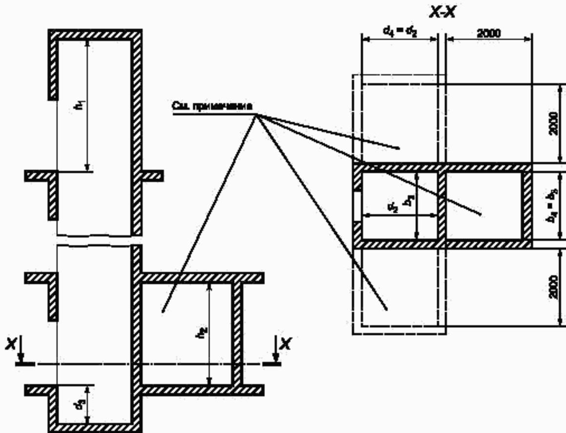
$b_1$  — ширина шахты;  $b_4$  — ширина машинного помещения;  $d_2$  — глубина шахты;  $d_3$  — глубина приямка;  $d_4$  — глубина машинного помещения;  $h_1$  — высота шахты от уровня верхней посадочной (погрузочной) площадки до выступающих частей перекрытия над шахтой;  $h_2$  — высота машинного помещения
