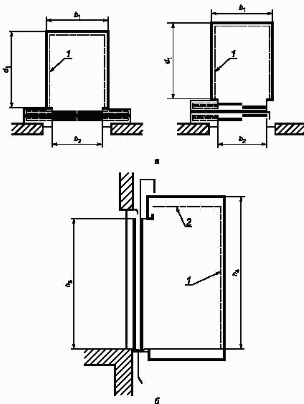
$b_1$  — ширина кабины;  $b_2$  — ширина дверного проема;  $d_1$  — глубина кабины;  $h_3$  — высота дверного проема;  $h_4$  — высота кабины; 1 — отделочные (декоративные) панели; 2 — подвесной потолок
