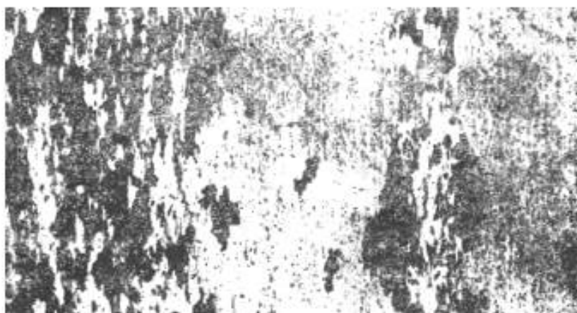
Рисунок А.18 — Крупнокристаллическая структура плакировки
