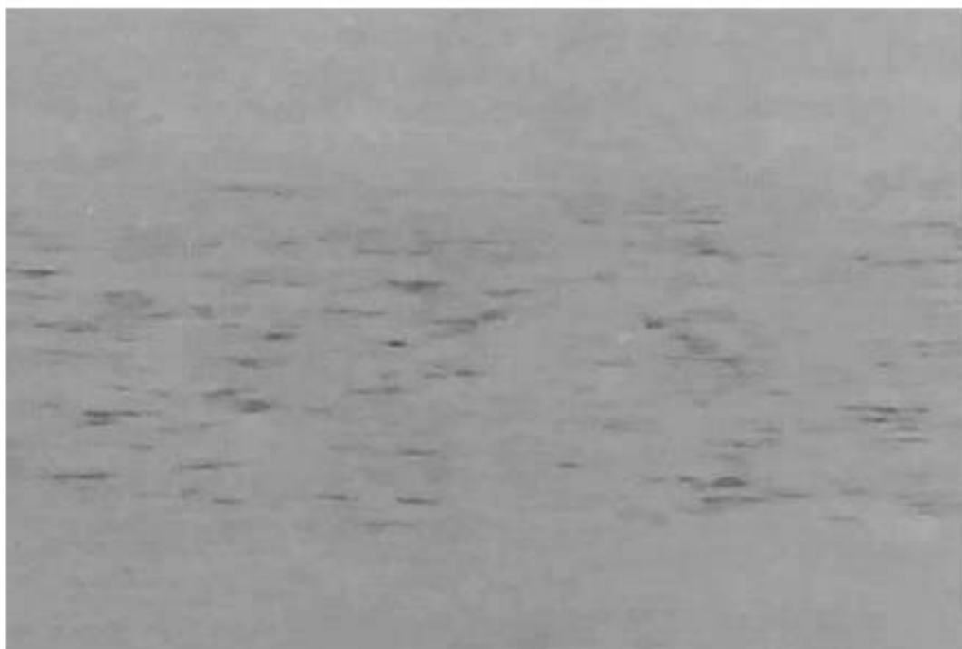
Рисунок А.50 — Пятна под лаковым покрытием
