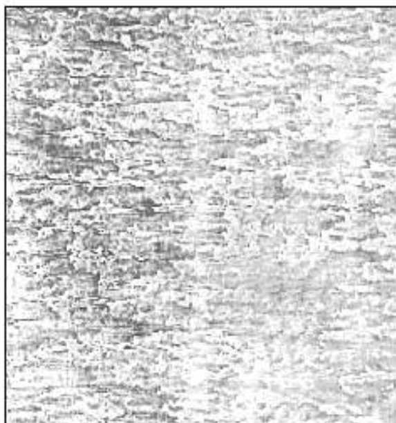
а — лист, светлая шероховатая поверхность; б — лист, светлая шероховатая поверхность с черными точками
