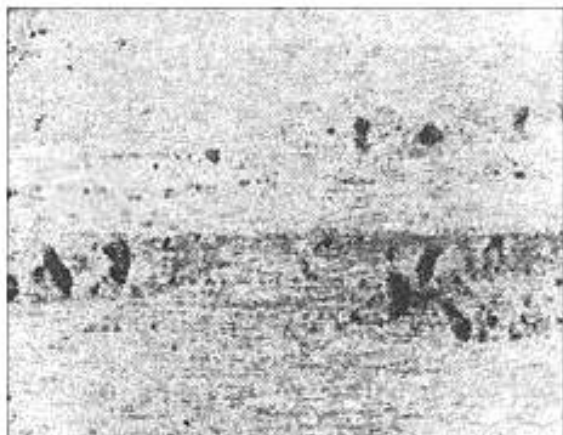
Рисунок А.12 — Закаты неметаллического материала
