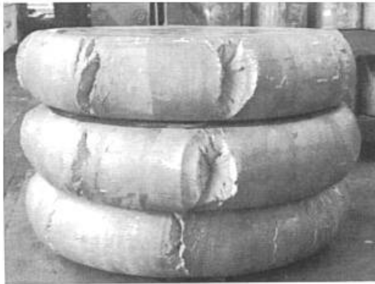
Трещина на поковке
