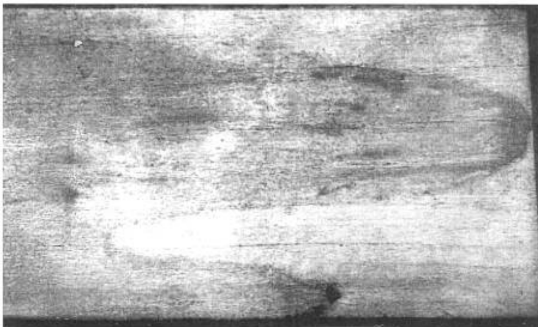
Рисунок А.29 — Пятна закалочные
