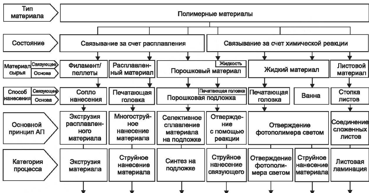
Рисунок В.3 — Обзор одношаговых аддитивных технологических процессов для полимерных материалов
