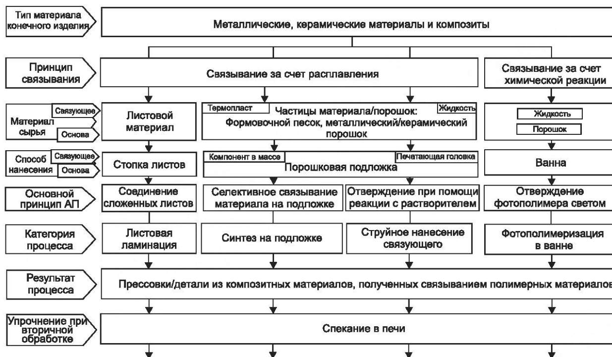
Рисунок В.5 — Описание многошаговых аддитивных технологических процессов для металлических, керамических и композитных материалов
