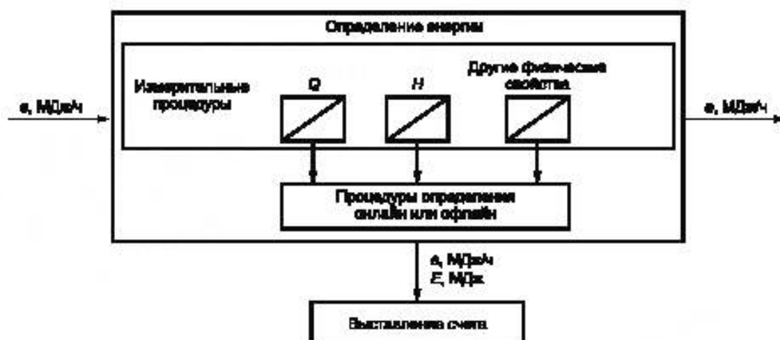
Рисунок 2 — Схема определения энергии косвенным методом
