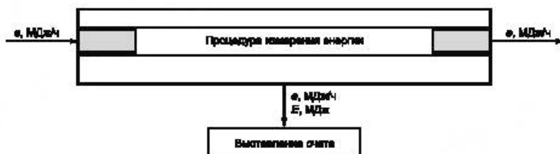
Рисунок 1 — Схема определения энергии прямым методом
