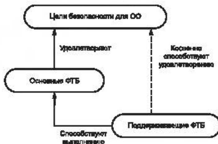
Рисунок 4 — Взаимосвязь основных и дополнительных ФТБ
