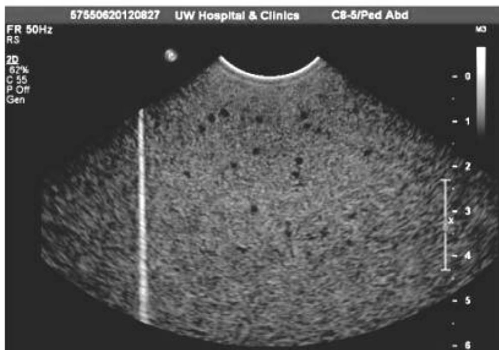
Рисунок D.2 — Изображение, полученное при использовании фантома, содержащего слабоотражающие сферы диаметром 2 мм, и педиатрического датчика с радиусом кривизны приблизительно 1,5 см
