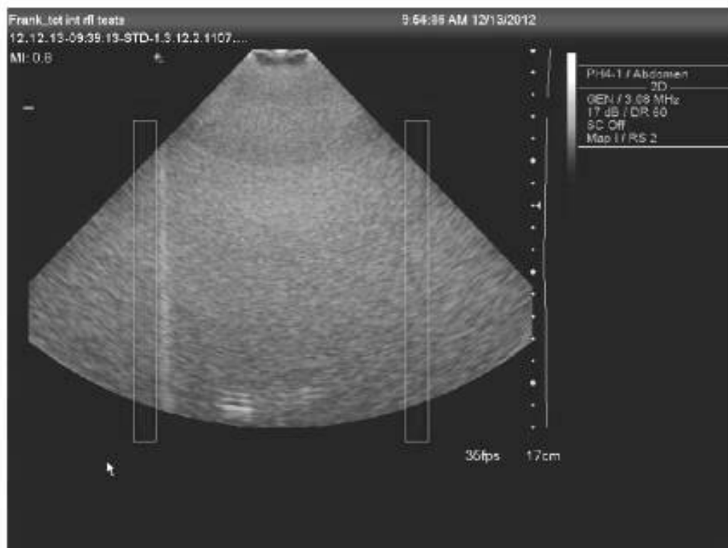
Рисунок F.1 — Усредненное изображение по 10 снимкам, полученным с помощью датчика с фазированной решеткой
