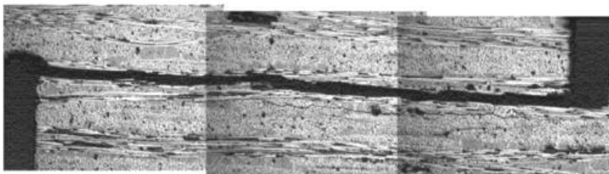
Рисунок 11 — Микрофотография образца с двойным надрезом после испытания
