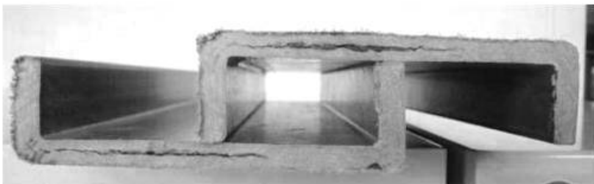
Рисунок А.8 — Расслоение
