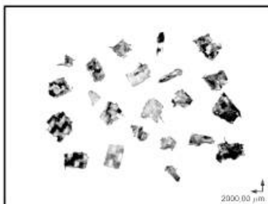
б — образцы измельченных полимерных композитов, армированных тканым углеродным наполнителем
