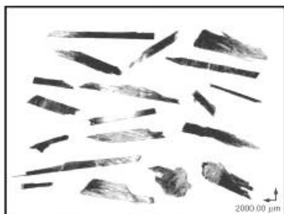
а — образцы измельченных полимерных композитов, армированных однонаправленным углеродным волокном
