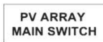
Рисунок В.5 — Пример знака на выключателе-разъединителе ФБ (главном выключателе ФБ) и идентичный знак МЭК.
