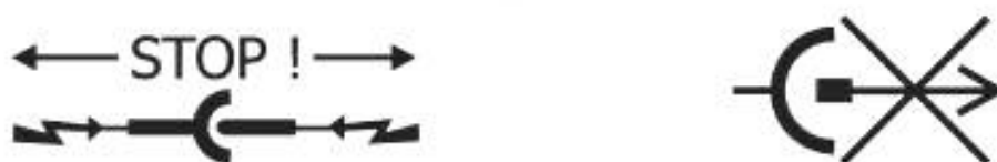
Рисунок В.4 — Примеры знака «Под напряжением! Не разъединять»
