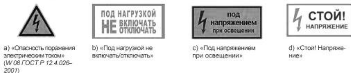
Рисунок В.3 — Примеры знаков, указывающих на то, что любой компонент ФБ может находиться под напряжением в любой момент времени независимо от того, разомкнуты или нет выключатели в ФБ
