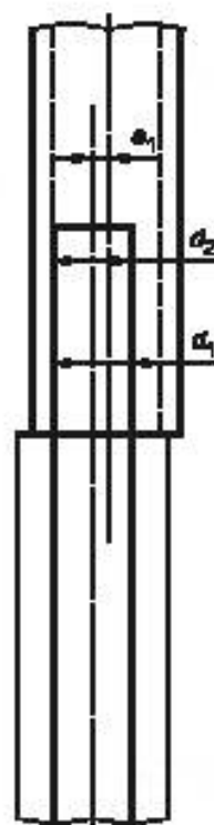
б) Эксцентриситет во втулочном соединении
