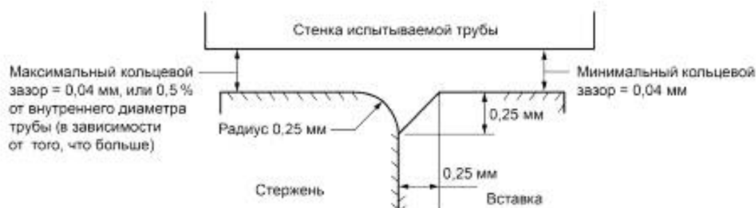
Рисунок 4 — Детальное изображение поверхности контакта между нажимным стержнем и вставкой
