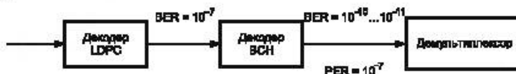
Рисунок К.1 — Соотношение битовых и пакетных ошибок в условиях квазибезошибочного приема
