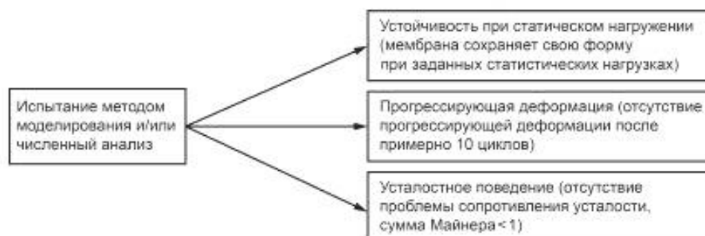
Рисунок 2 — Технологическая схема расчета для мембран
