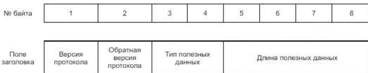
Рисунок 9 — Структура заголовка сообщения V2GTP
