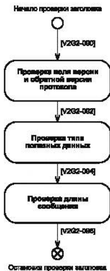
Рисунок 10 — Обработка типового заголовка V2GTP
