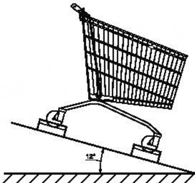
Рисунок Г.2 — Положение тележки на испытательной платформе
