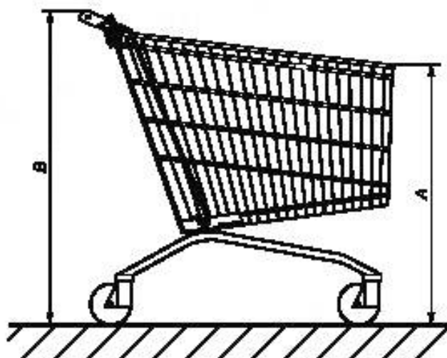
Рисунок В.3 — Измерение размеров A и B
