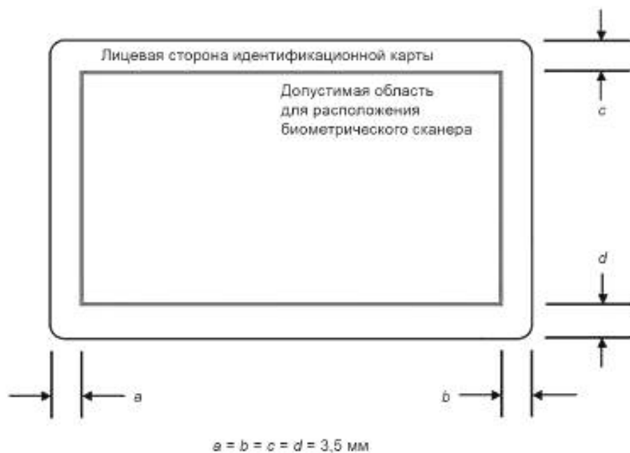
Рисунок 1 — Допустимая область для расположения биометрического сканера на лицевой стороне идентификационной карты
