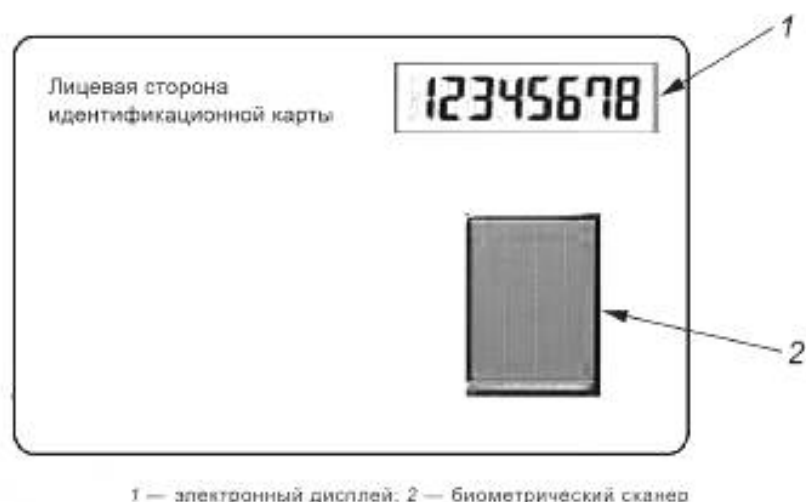
Рисунок 3 — Пример BSoC с электронным дисплеем
