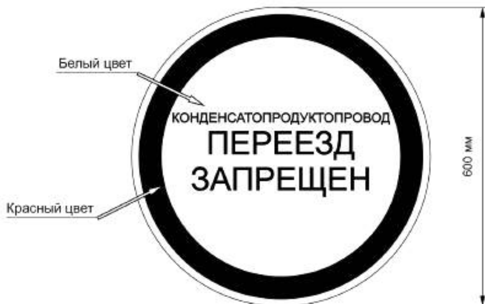
Рисунок Е.8 — Знак «Конденсаторопродуктопровод. Переезд запрещен»
