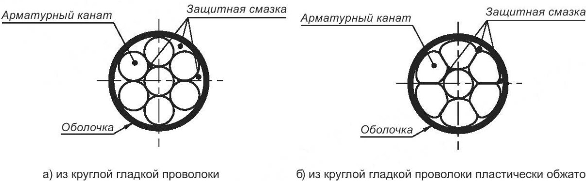
Рисунок 1— Конструкция защищенного каната в оболочке
