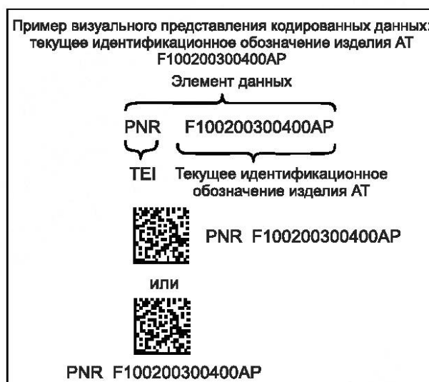
Рисунок 8 — Примеры представления для визуального чтения, данные кодированы с применением идентификатора PNR (TEI)
