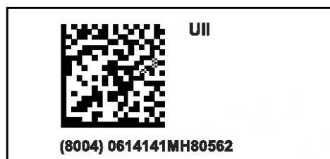
Рисунок 10 — Пример представления символа ШК символики Data Matrix и знаков для визуального чтения в составе маркировки, содержащей строку элемента данных GIAI с идентификатором применения GS1 (8004)
