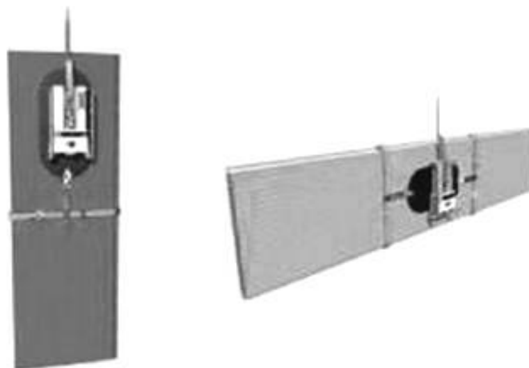
Рисунок 8 — Монтаж стеновых сэндвич-панелей вакуумным захватом для стекол
