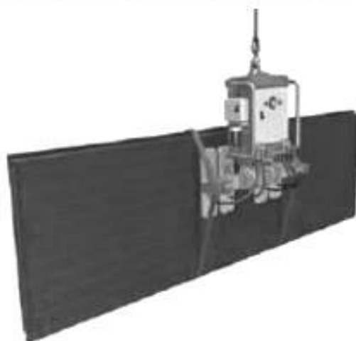
Рисунок 4 — Рекомендуемая конфигурация вакуумного захвата для горизонтальных стеновых сэндвич-панелей длиной до 12 м
