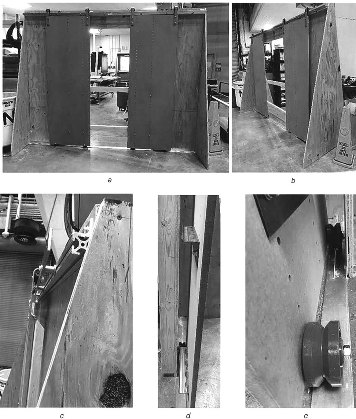
a — вид спереди; b — вид сбоку; c — верхняя направляющая двери; d — опоры для вертикальных ограничителей; e — колесо раздвижной двери и направляющая
