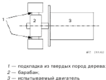
Рисунок В.1 — Способ определения скорости втягивания
