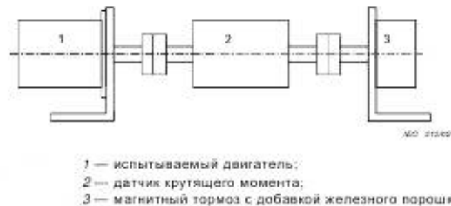
Рисунок В.2 — Испытательный стенд для измерения опрокидывающего момента при помощи датчика крутящего момента и магнитного тормоза с добавкой железного порошка
