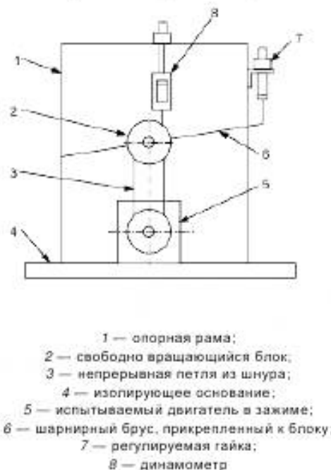
Рисунок В.4 — Метод измерения опрокидывающего момента при помощи шнура и динамометра
