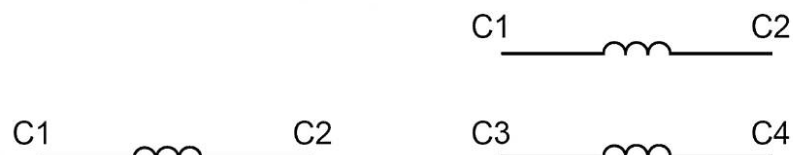
Рисунок 18 — Компенсирующая обмотка, один и два элемента
