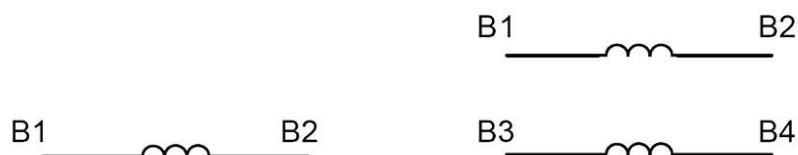
Рисунок 17 — Коммутационная обмотка, один и два элемента
