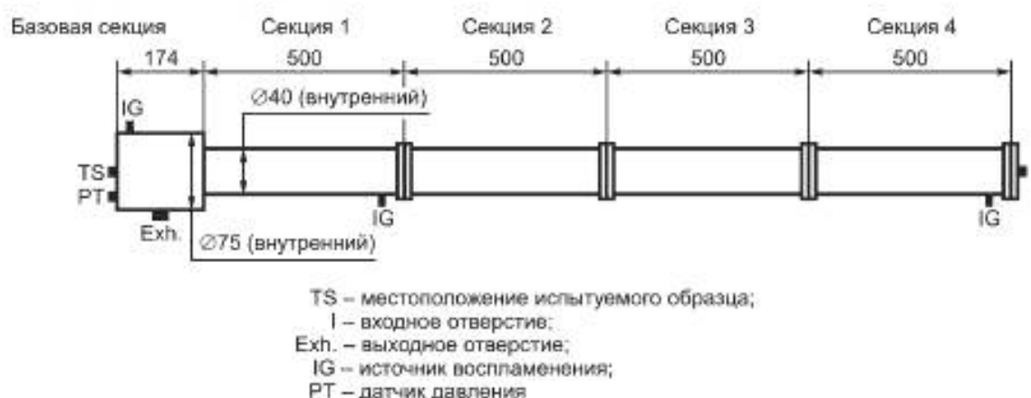
Рисунок 21 — Установка для испытаний дыхательных и дренажных устройств
