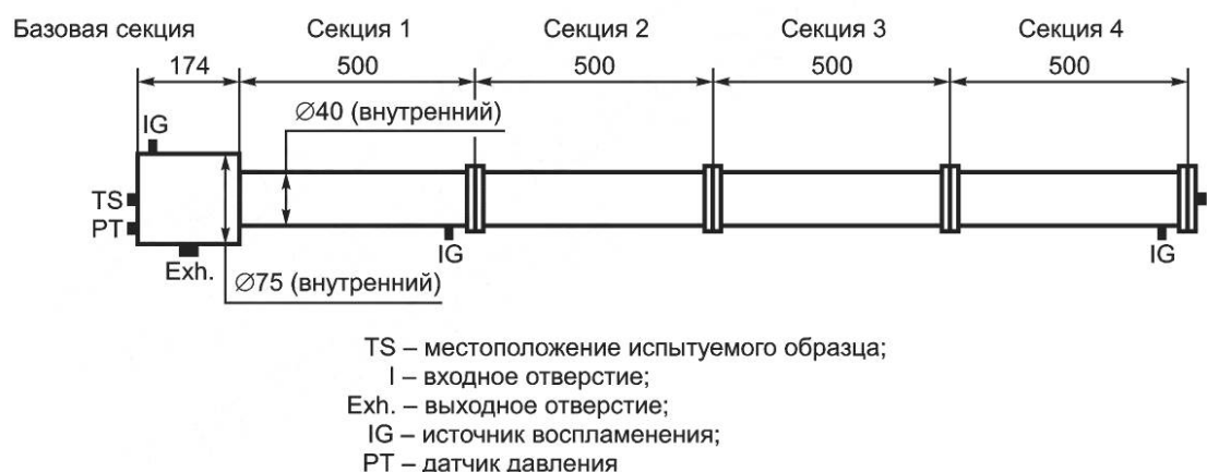
Рисунок 21 — Установка для испытаний дыхательных и дренажных устройств
