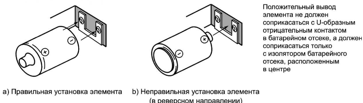
Рисунок В.4 — Отрицательный контакт U-образной формы в батарейном отсеке, обеспечивающий невозможность электрического контакта с положительным выводом элемента
