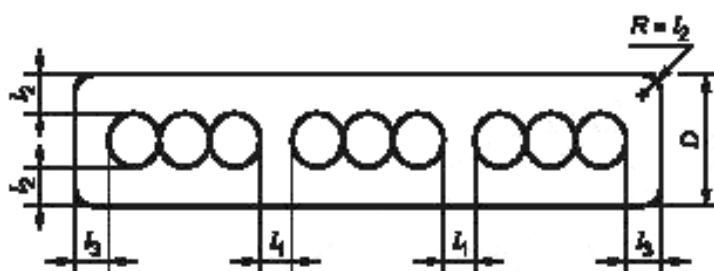
Рисунок 1 — Поперечное сечение кабеля (Рисунок приведен для иллюстрации толщины оболочки и значения просвета, приведенных в таблице 4, и не определяет действительную конструкцию.)
