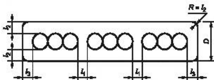
Рисунок 1 — Поперечное сечение кабеля (Рисунок приведен для иллюстрации толщины оболочки и значения просвета, приведенных в таблице 4, и не определяет действительную конструкцию.)
