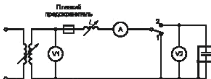
Рисунок 2 — Испытательная установка для разрушающего испытания переменным напряжением
