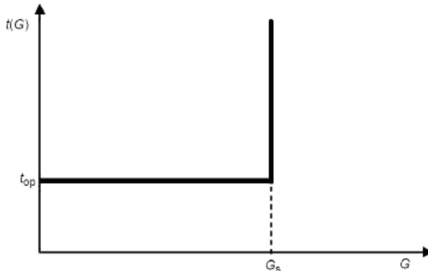
Рисунок 3 — Независимая характеристика времени реле недостаточного напряжения
